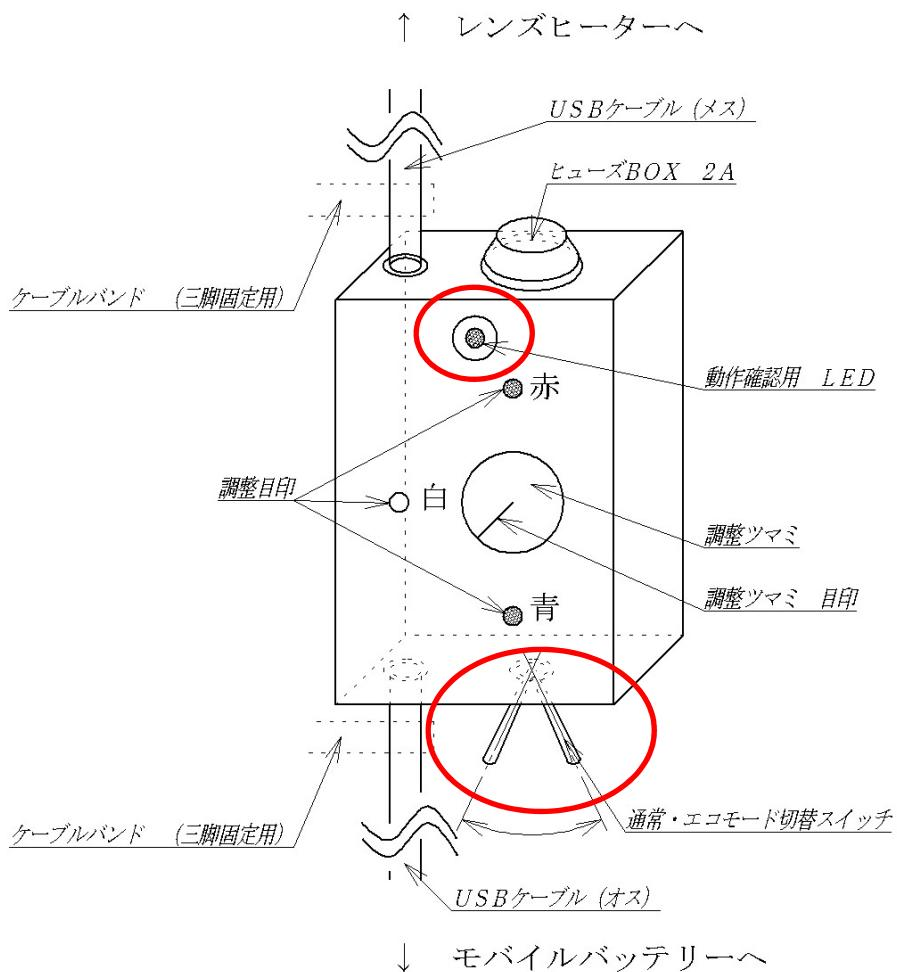
スイッチを左右何方かに動かすと、確認用 LEDが点灯、点滅します。
