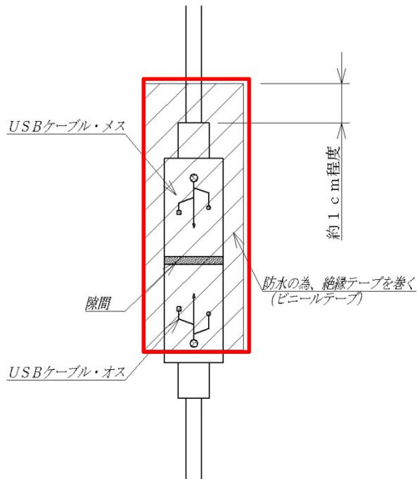
USB端子を接続しても隙間があり、ケーブルを伝って、接続部の隙間より
